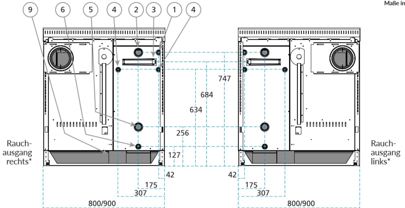
Der zur Verfügung stehende Zwischenraum zwischen Anschlüssen und der Wand des Aufstellraums beträgt ca. 30 mm. Bei Bedarf könnte es notwendig sein, einen größeren Zwischenraum mit einem in der Tiefe verlängerten Herdrahmen oder mit einer Nische in der Wand zu schaffen.
